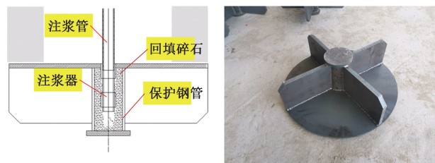
图 1 注浆器内置的注浆桩尖
