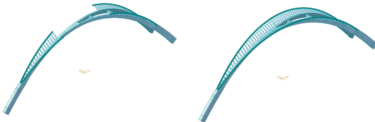
图 3 副拱肋及连接肋关键施工阶段有限元模型
