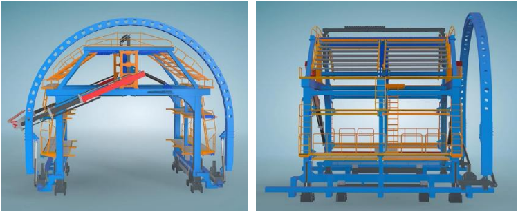
8 防水板挂布与钢筋绑扎台车
