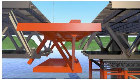
**图 12 BIM 模拟发现合龙段斜腹杆碰撞**
