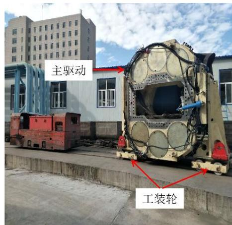
图 4 主驱动工装轮实际安装效果
