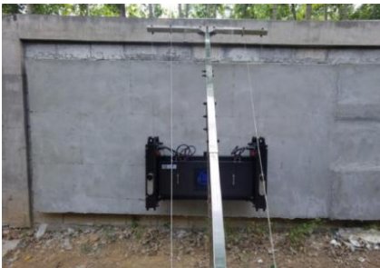
图7 雷达扫描的现场操作
