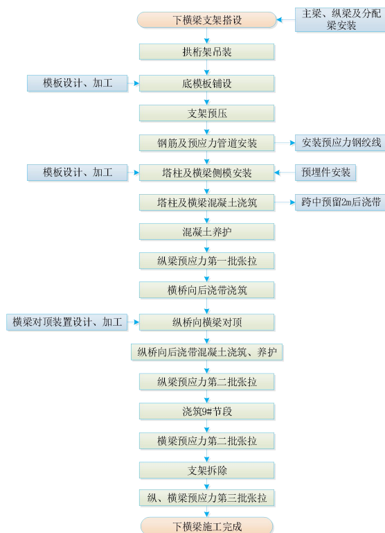
图2 施工工艺流程
