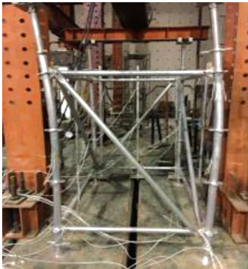
图5 架体稳定性试验
