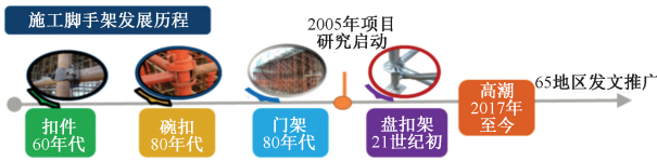
图1 中国施工脚手架发展历程
