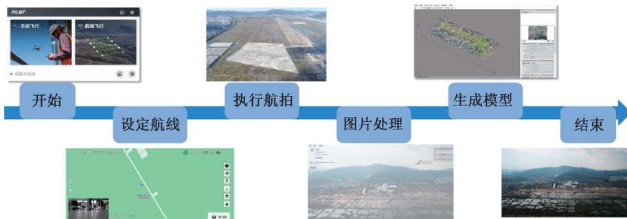
图 19 基于 BIM 的倾斜摄影建模
