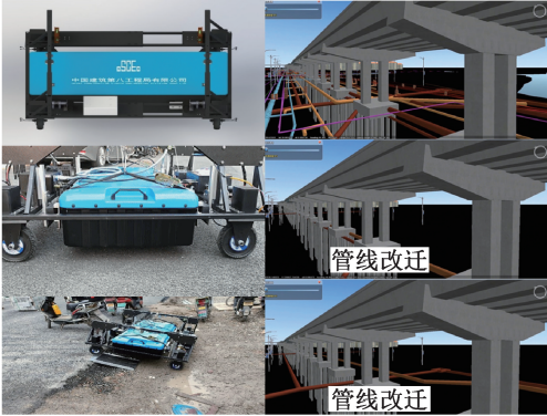
图 20 三维探地雷达的应用
