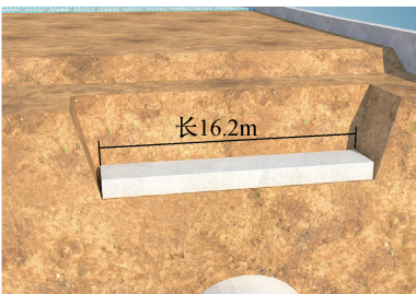
图 9 C4 基坑标准块开挖
