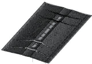
图 4 钢屋盖结构数值模拟模型
