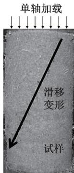
图 7 轻质混合土试样加载变形
