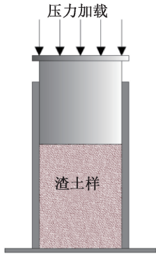
图1 泥饼压制装置原理
