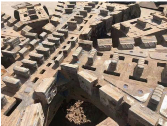
图 9 始发段盾构刀盘损伤
