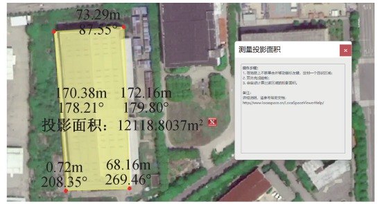
图 6 建筑轮廓数据测取
