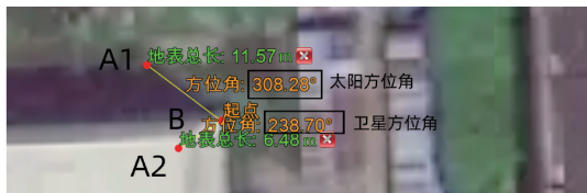
图 7 反推建筑高度所需数据测取
