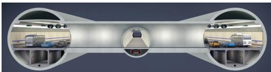
图 1 盾构隧道横断面
