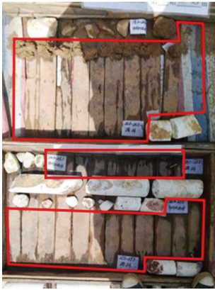
图 7 基坑底部勘察钻孔 Fig. 7 Foundation excavation bottom survey borehole
