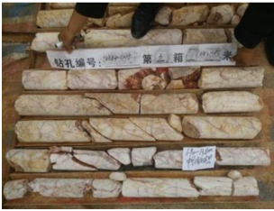
图 5 岩芯样中的溶蚀裂隙 Fig. 5 Karst fissures in cores
