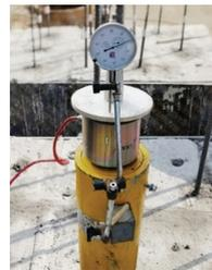
图 4 拉拔试验
