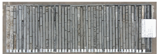
图 7 防渗墙取芯完整性实物
