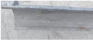
图 13 模板首次脱模后内表面状态
