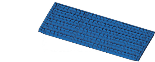
图 5 钢-UHPC 组合箱梁桥有限元模型
