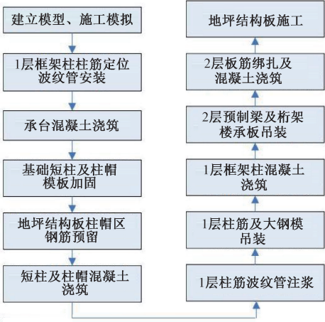
图 1 施工工艺流程 Fig. 1 Construction process
