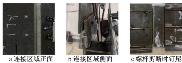
图 5 试件 S6.3/2-J1-3 的破坏现象
