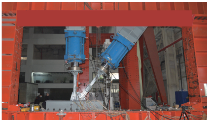
图 3 加载装置 Fig. 3 Loading device –36.7kN。为进一步研究节点是否满足强节点、弱杆件性能化设计要求,以杆件全截面应力状态确定荷载施加值。第 2~4 加载阶段分别为组合加载至杆件全截面达到材料强度设计值、材料强度屈服值和材料强度极限值的荷载工况。
