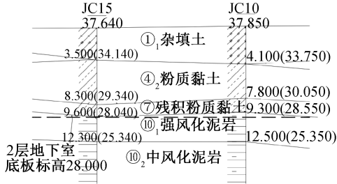
图 3 地下 2 层渗漏严重处剖面 Fig. 3 Section of severe water leakage areas on B2 floor
