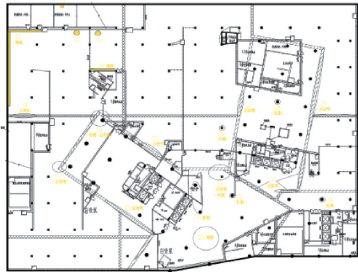
图 1 地下 2 层上浮点布置 Fig. 1 Layout of uplift points on B2 floor
