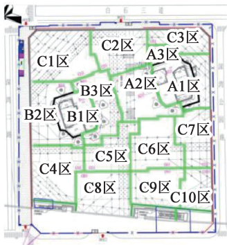
图6 地下室混凝土结构施工分区 Fig. 6 Construction zoning plan for the basement concrete structure
