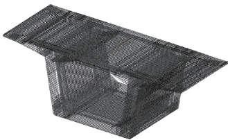
图 9 节段梁普通钢筋布置
