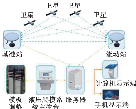
图 1 GNSS 模板监测原理
