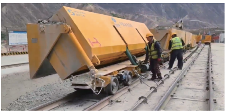
图 4 侧卸车编组 Fig. 4 Side-dumping muck car formation
