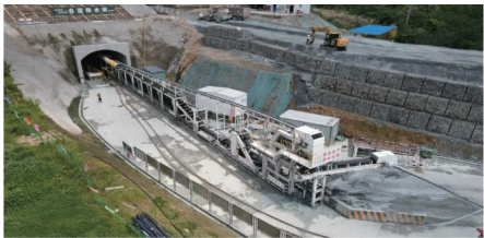
图 8 连续皮带机 Fig. 8 Continuous belt conveyor
