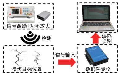
图2 压电波法结构缺陷识别原理
