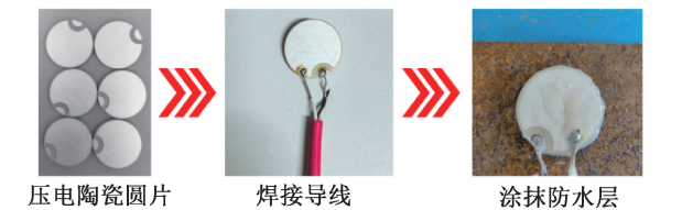
图 3 压电陶瓷传感器制作流程
