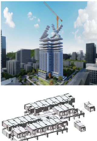
图 1 箱模-现浇剪力墙体系 Fig.1 Box module-cast-in-place shear wall system
