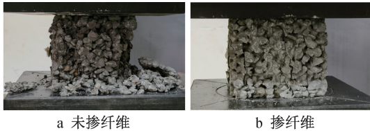
图 4 RAPC 立方体抗压破坏形态
