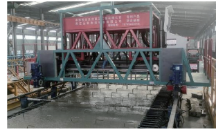
图 12 顶板振捣拉毛一体机
