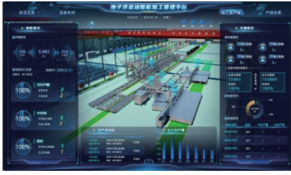
图 14 钢筋骨架自动化生产线数字孪生
