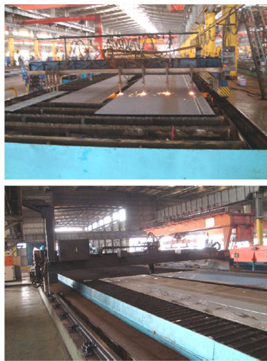
图6 零件的自动下料与焊接
